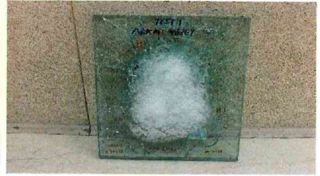
Atış Sonrası Test Numunesinde Kullanılan Tanık Materyalin Resmi Image of Witness Material Used in the Test Sample After Shooting
